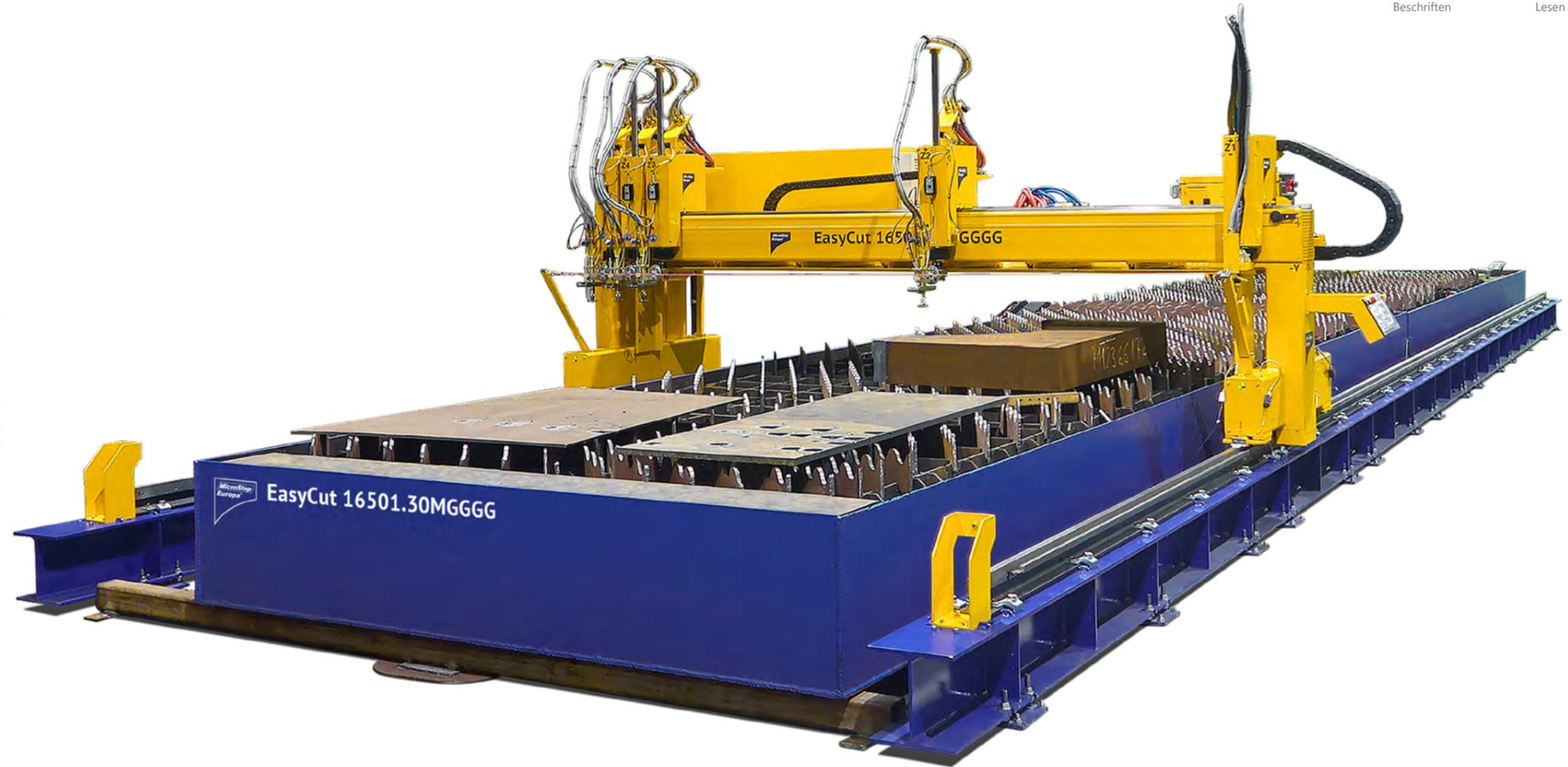
Mehrbrenner-Betrieb mit parallel bis zu 6 Werkzeugen auf einem Portal
