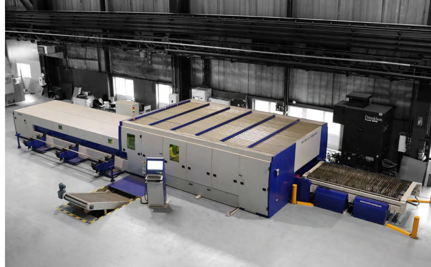
Flexible und hochdynamische CNC-Faserlaser-Schneidanlage bis 30 kW
