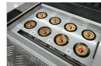
Um den Automatisierungsgrad zu erhöhen und damit die Produktivität weiter zu steigern, können unsere Lasersysteme mit einem automatischen Düsenwechselsystem ausgestattet werden. Dadurch kann Bedienpersonal effizienter eingesetzt werden. Gleichzeitig werden die Stillstandszeiten der Maschine reduziert.
