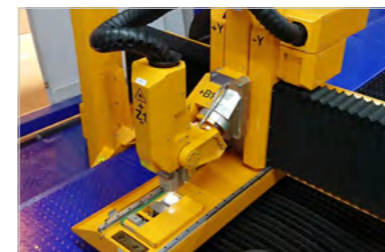
Direkt am Portal integriert: die Kalibriereinheit ACTG®
