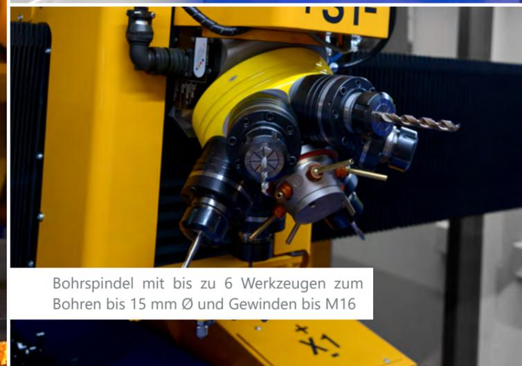
Bohrspindel mit bis zu 6 Werkzeugen zum Bohren bis 15 mm Ø und Gewinden bis M16
