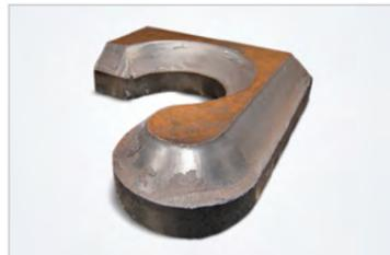
Bauteile mit sehr großen Materialstärken, bei denen ein direktes Anfasen nicht mehr möglich ist, können dank des neuen Additional Beveling Process (ABP) vollautomatisch nachträglich angefasst werden. Präzise, kostensparend und ohne zusätzliches Handling zu einer weiteren Anlage. Dabei können V-, Y-, X- sowie K-Fasen realisiert werden.
