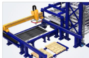
Der rotationsfähige Sortiersupport des MSSort verfügt über einen automatischen Austausch von Greifwerkzeugen, die jeweils für verschiedene Formen und Größen von geschnittenen Teilen ausgelegt sind.
