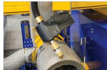
Die zu bearbeitenden Rohre und Profile können ab einem Durchmesser von 30 mm bis zu 1.000 mm geschnitten und mit Schweißnahtvorbereitungen versehen werden.
