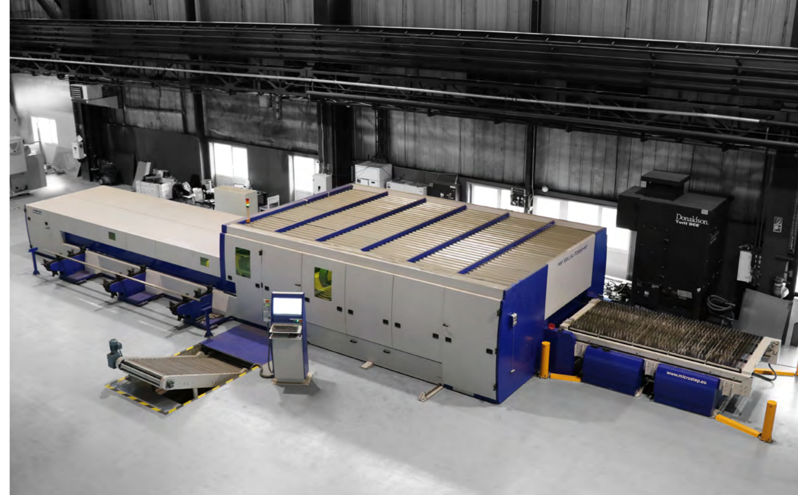
Flexible und hochdynamische CNC-Faserlaser-Schneidanlage bis 30 kW
