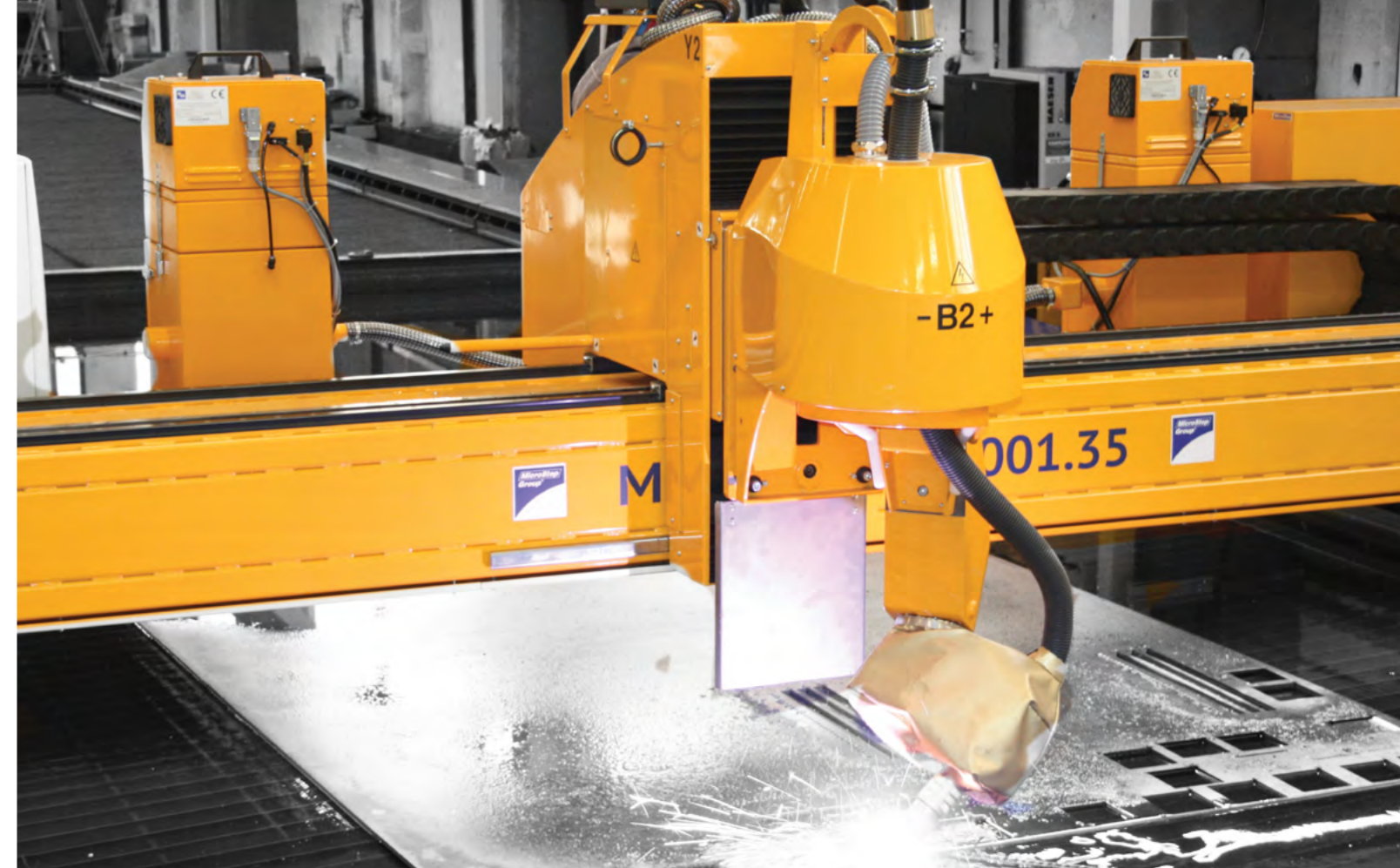
Der Plasmarotator beim Fasenschneiden auf einem Wassertisch
