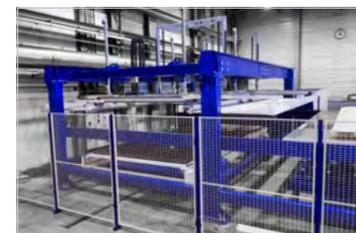
Sicherheit steht bei der Materialhandhabung an erster Stelle. Das System ist durch abschließbare Zäune und optische Barrieren gesichert, die das System beim Betreten des Arbeitsbereichs stoppen.
