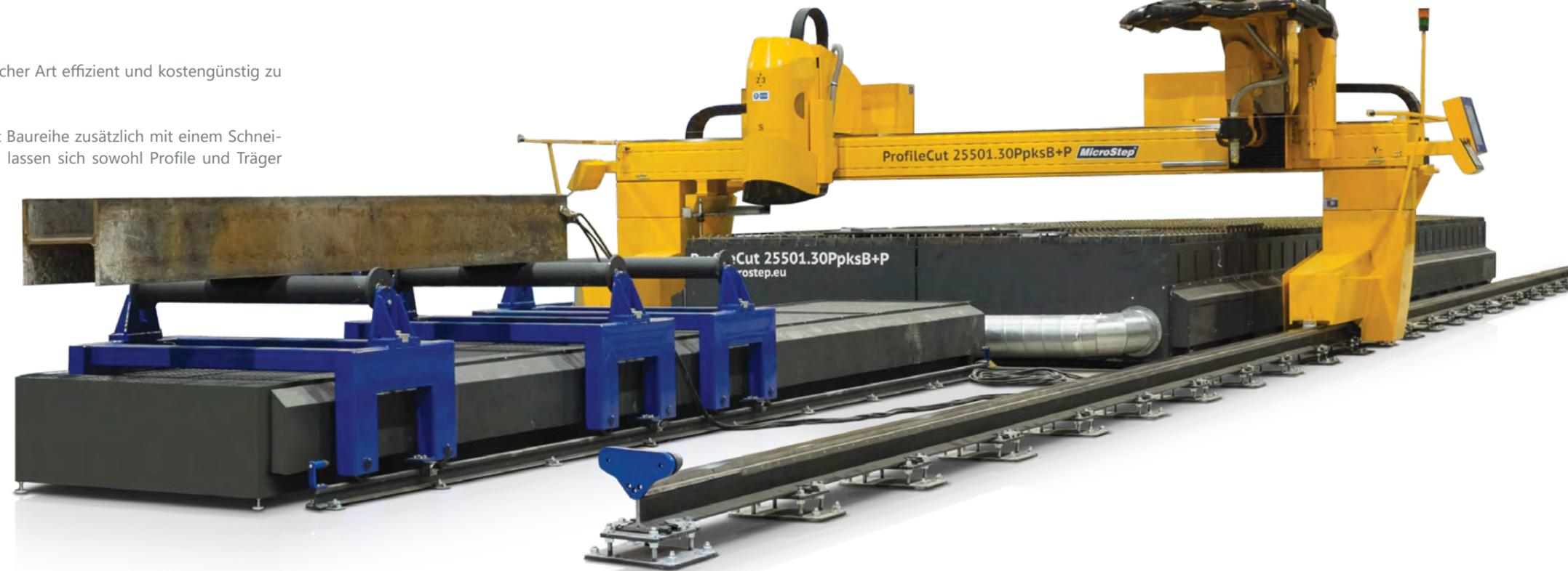
3D Profil- & Trägerbearbeitung bis 1.000 mm Höhe und 24 m Länge
