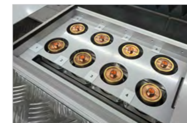
Systeme für noch mehr Effizienz: Automatischer Düsenwechsel
