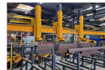
Neue Technologie für maximale Produktivität: Der modulare Aufbau der PipeCut ermöglicht es, die Maschine mit einem maßgeschneiderten Rohr- und Profilsortiersystem zu erweitern. Die vollautomatische Rohrsortierung ist in den Entladebereich der Maschine integriert und wird in Bezug auf die Länge der geschnittenen Rohre und die Anordnung der Entladepositionen konfiguriert, um die beste Sortiereffizienz zu gewährleisten.
