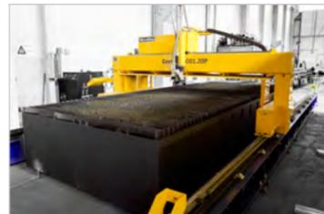
Extreme Bedingungen stellen eine große Anforderung an eine Schneidanlage. Bei der EasyCut von MicroStep gibt es bei Bedarf für verschiedenste Temperaturbereiche (-10° bis +45°) und weitere Umgebungsvariablen eine passende Lösung. Das System ist widerstandsfähig gegen Schmutz, Staub und Feuchtigkeit. Der robuste Maschinenbau sorgt für Langlebigkeit auch bei schwerem Schneidbetrieb.
