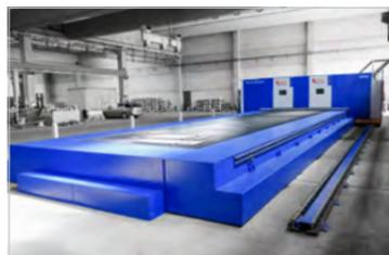
Der MSF Max stellt mit seiner maximalen Bearbeitungslänge von bis zu 50.000 mm und seiner maximalen Bearbeitungsbreite von bis zu 6.000 mm eine außerordentliche Laserslösung für Großanwendungen dar. Das ursprünglich für den Schiffsbau entwickelte Faserlaserschneidsystem ist für die zuverlässige und präzise Bearbeitung von großen Bauteilen geschaffen. Der Aufbau macht den MSF Max zu einer hochbelastbaren Faserlaserschneidanlage für komplexe und außergewöhnliche Schneidaufgaben.
