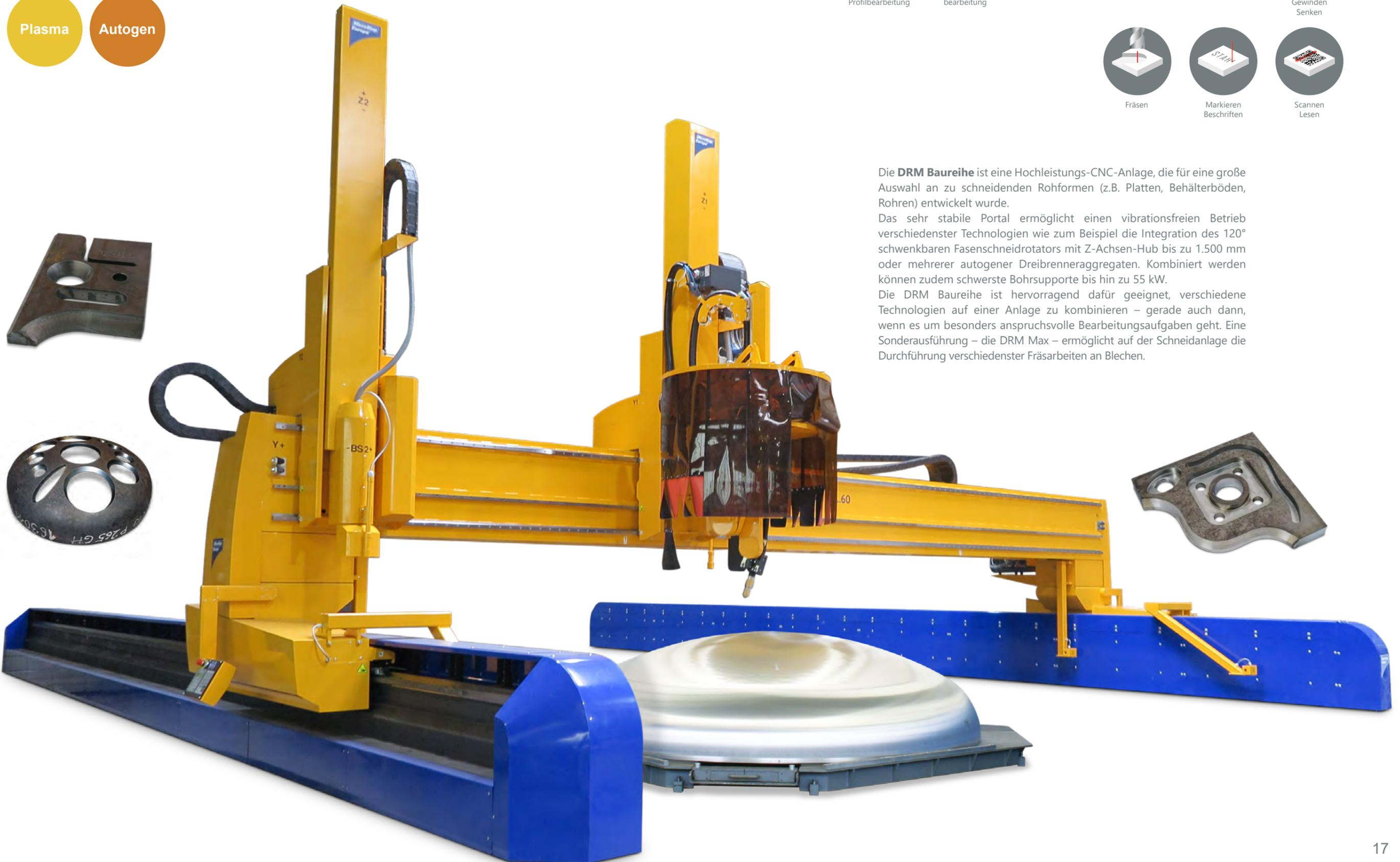
Die **DRM Baureihe** ist eine Hochleistungs-CNC-Anlage, die für eine große Auswahl an zu schneidenden Rohformen (z.B. Platten, Behälterböden, Rohren) entwickelt wurde.
