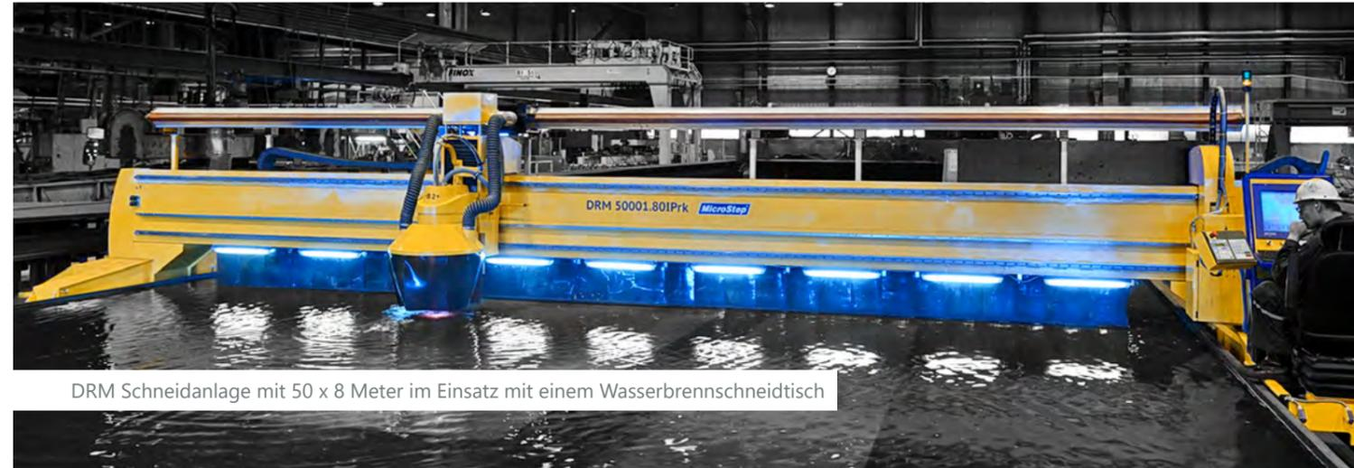
DRM Schneidanlage mit 50 x 8 Meter im Einsatz mit einem Wasserbrennschneidstisch
