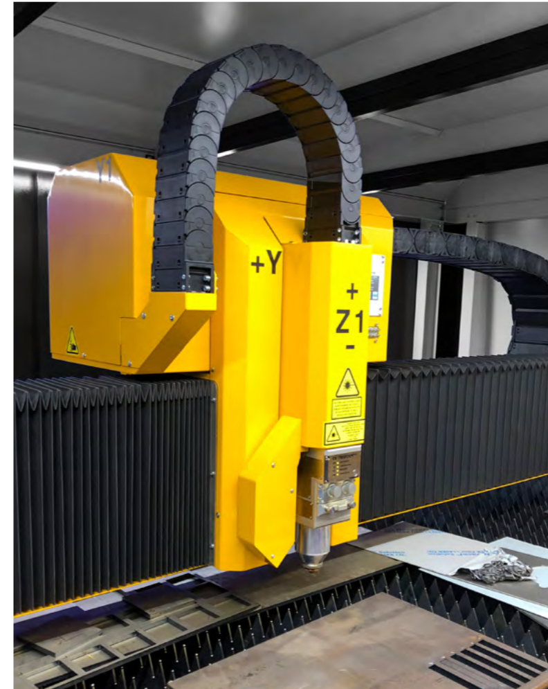
Der Schneidisch ist für Materialstärken bis 15 mm ausgelegt
