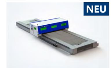
Die Faserlaserserie zur Bearbeitung großformatiger Bleche ist auch in der Sonderausführung MSF Max C erhältlich. Wichtigster Unterschied: Der Schneidbereich wird lediglich durch eine kompakte Light-Weight-Sicherheitskabine abgeschirmt. Wichtigster Vorteil: Bei vergleichbarer Größe des Arbeitsbereichs benötigt der MSF Max C deutlich weniger Aufstellfläche als der MSF Max in herkömmlicher Bauweise.
