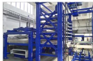
Im Standard ist der MSTower für Blechformate von 3.000 x 1.500 bis 6.000 x 2.000 mm erhältlich und bietet Platz für bis zu 10 Kassetten. Auf Wunsch sind auch andere Maße erhältlich. MicroStep bietet kundenspezifische Lösungen in Bezug auf Kassettengröße und Kassettenanzahl – auch die Integration mit ergänzender oder bereits bestehender Technologie kann realisiert werden.
