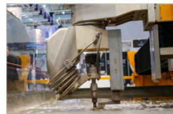
Für präzise Fasenschnitte sowie eine effiziente Schweißnahtvorbereitung bis 45° ist es möglich die WaterCut mit einem 3D-Schneidkopf auszurüsten. Die Baureihe kann ebenfalls mit zwei 2D-Schneidköpfen ausgestattet werden – für noch mehr Flexibilität oder einen noch schnelleren Parallelschneidbetrieb.
