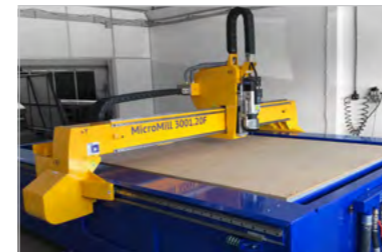
Ausgezeichnete Dynamik mit Positioniergeschwindigkeiten bis zu 56 m/min
