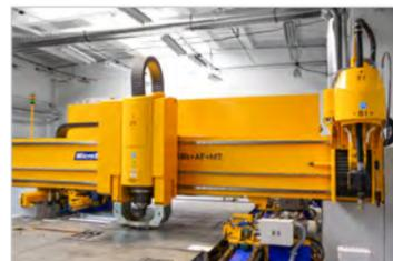
Die DS Baureihe ist ein CNC-Schneidsystem, das eine Vielzahl an Bearbeitungsoptionen für Flachmaterial bietet. Mit einem Plasmarotator können 2D-Schnitte wie auch Schweißnahtvorbereitungen bis zu 50° eingebracht werden, zudem stehen Lösungen zum autogenen Brennschneiden, zum Bohren, Senken, Gewinden sowie zum Scannen und Markieren zur Verfügung. Im Standard beträgt die Bearbeitungsfläche 6.000 x 2.000 mm.
