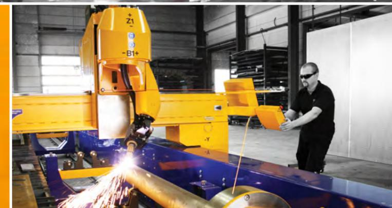
Rohrschneiden auf einer MG Anlage
