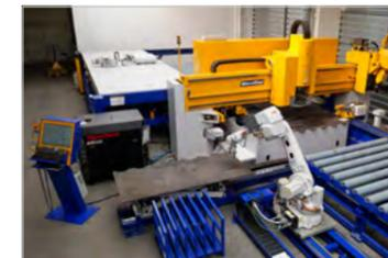
Als zeit- und kosteneffiziente Produktionslösung weist die DS Baureihe einen hohen Automatisierungsgrad auf. Die Beladung der Bleche in die Schneidzone, die Entladung der bearbeiteten Teile und die Separierung vom Restmaterial geschieht vollautomatisch. Der modulare Aufbau der Maschine ermöglicht eine individuelle Anpassung des Entladevorgangs einschließlich der Sortierung per Roboter.
