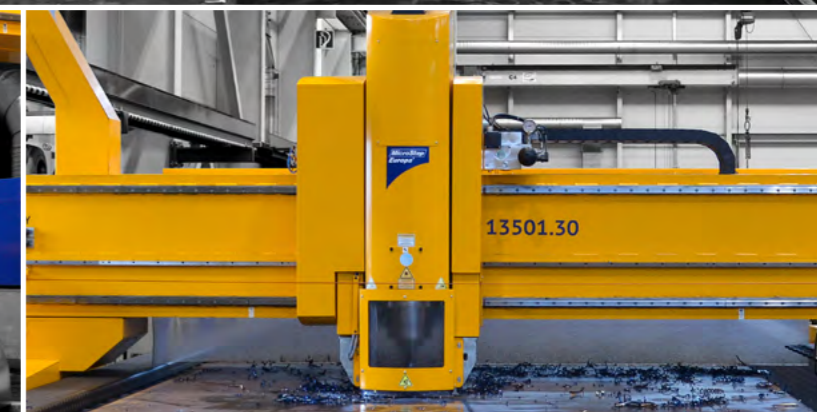
Automatisches Bohren mit bis zu 55 kW, innengekühlten Werkzeugen und Spezialbohrstisch
