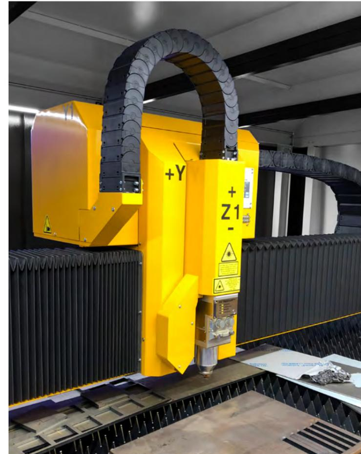
Der Schneidstisch ist für Materialstärken bis 15 mm ausgelegt
