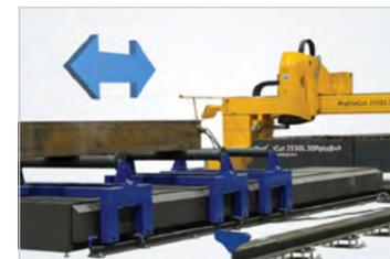
Dank des großen offenen Ladebereichs können selbst schwere Profile und Träger einfach und sicher über die massiven Auflageblöcke in die Bearbeitungszone gefahren werden. Das spart Zeit, da die Profile nicht gespannt oder anderweitig für die Bearbeitung vorbereitet werden müssen.
