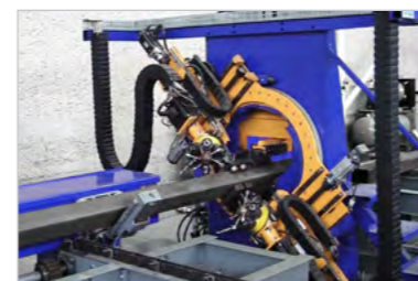
Sondervariante DS-B: Bohrlösung für Profile
