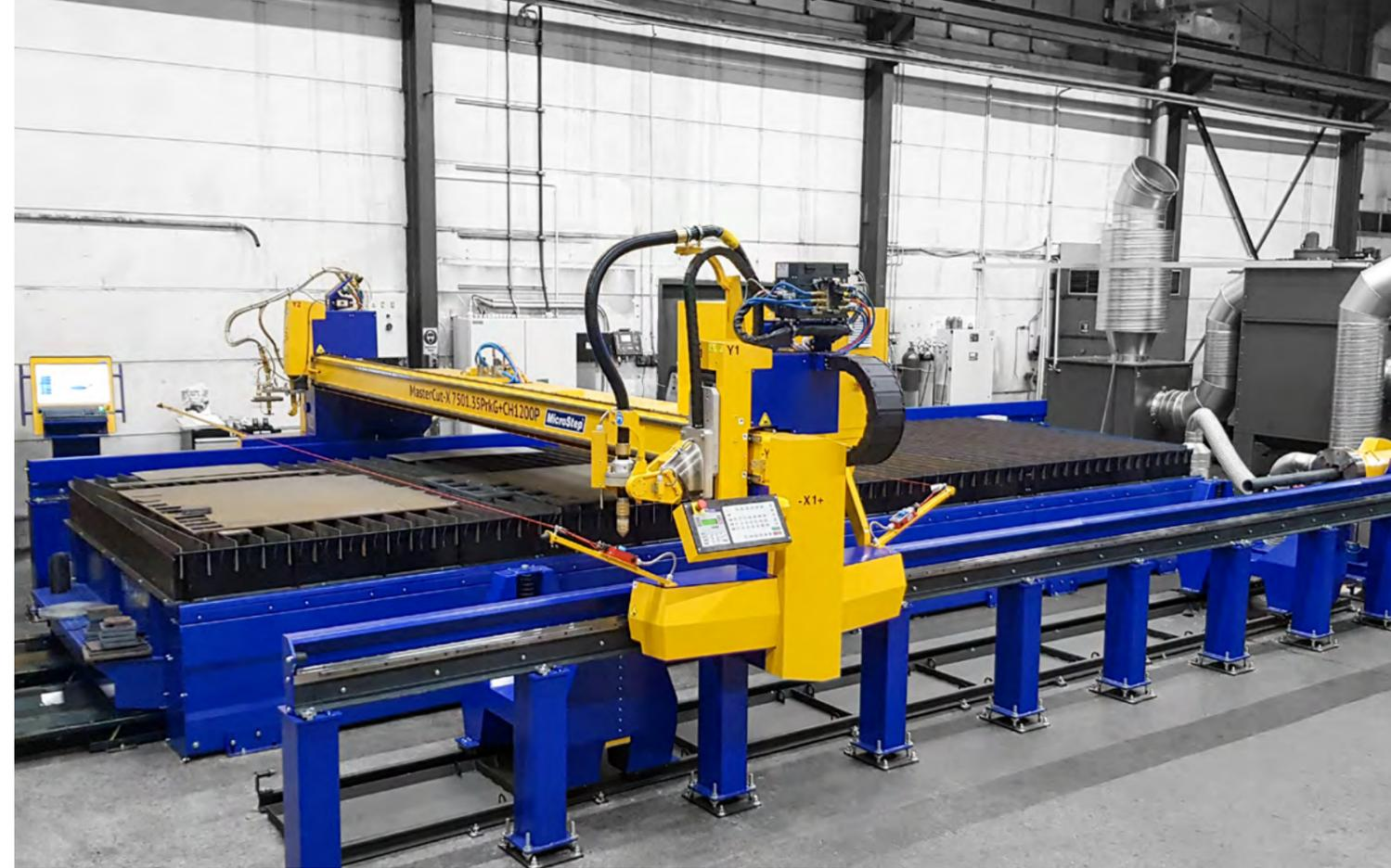
MasterCut mit Linearführungen in der X-Achse und Schacht zur Rohrbearbeitung
