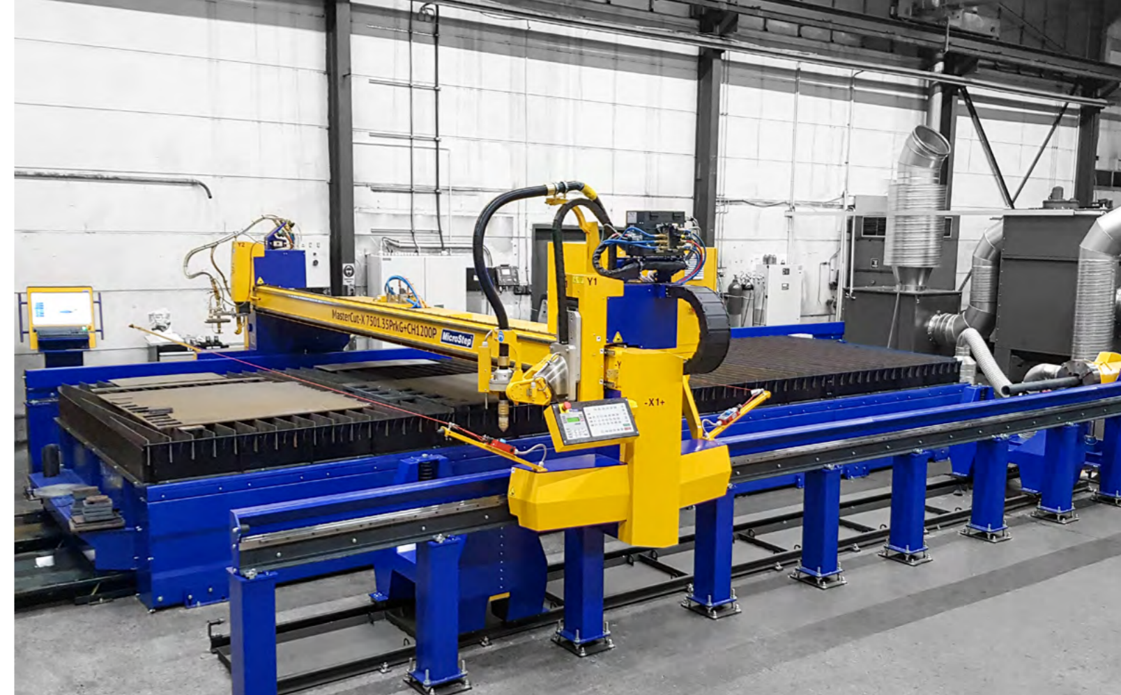
MasterCut mit Linearführungen in der X-Achse und Schacht zur Rohrbearbeitung
