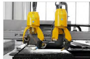
Der endlos drehende Rotator liefert hochqualitative Schweißnahtvorbereitungen bis 50° (Plasma) bzw. 60° (Autogen) an Blechen, Rohren, Profilen und Behälterböden. Das neue, extrem kompakte Design sorgt für höchste Präzision und Dynamik, so dass auch komplexe Fasen-Konturen verlässlich geschnitten werden können.
