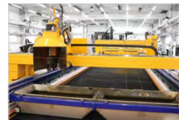
Eine mitfahrende Absaugwanne bewegt sich zusammen mit dem Portal zwischen dem oberen und dem unteren Tisch. Diese Wanne fängt herunterfallenden Schneidabfall auf und sorgt über die Verbindung zu seitlichen Luftkanälen gleichzeitig für eine effiziente Absaugung von entstehenden Rauchen und Stäuben. Darüber hinaus ist jeder Tisch mit zwei Kehrmaschinen am vorderen und hinteren Ende ausgestattet: diese befördern Restabfälle in Abfallbehälter, die sich zwischen den Zonen unter dem Boden befinden.
