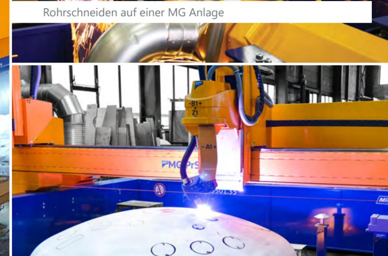
Behälterbodenbearbeitung auf einem multifunktionalen MG Schneidcenter
