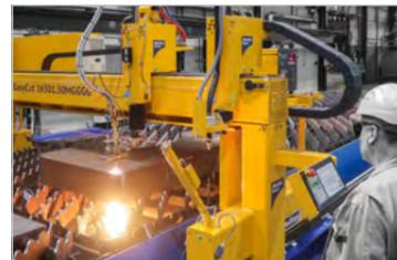
Der konsequent durchdachte Maschinenbau bietet mit seiner Ausstattung eine verlässliche Basis auch für hohe Materialstärken von bis zu 300 mm. Ein intelligentes Temperaturmanagement lässt die Anlage auch im Mehrschichtbetrieb nie in Grenzbereiche vordringen.
