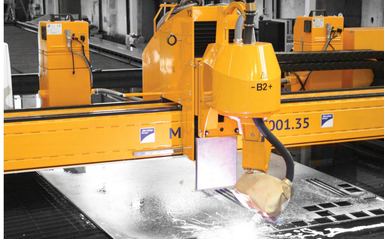
Der Plasmarotator beim Fasenschneiden auf einem Wassertisch
