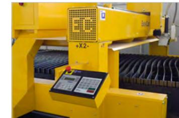
Neben der extern positionierten Steuerungskonsole mit ergonomischem 24"-Touchscreen-Display, verfügt die Anlage über zusätzliche Bedienkonsolen an der Portalbrücke. Somit kann der Bediener unkompliziert ein Schneidprogramm unterbrechen, die Anlage manuell verfahren, eine neue Blechtafel einlesen oder schnell einen Handschnitt durchführen.
