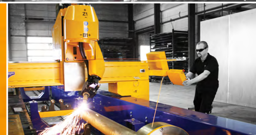
Rohrschneiden auf einer MG Anlage
