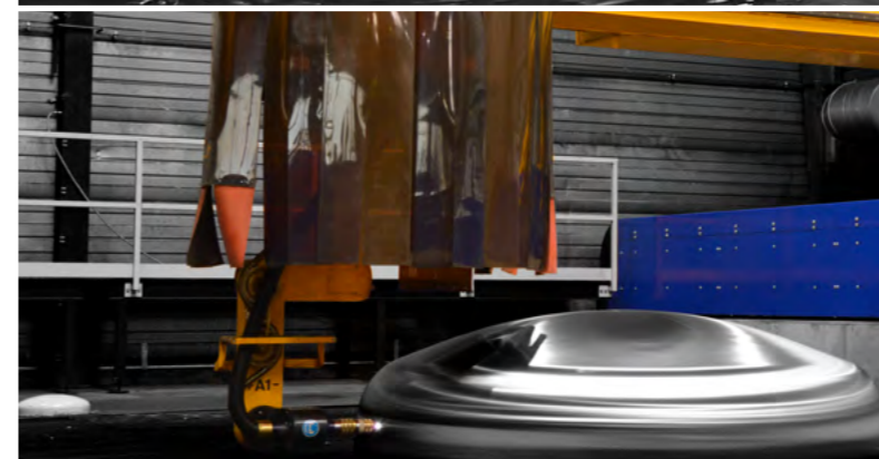
Behälterbodenbearbeitung mit der DRM und speziellem Plasmarotator (bis 120° schwenkbar)
