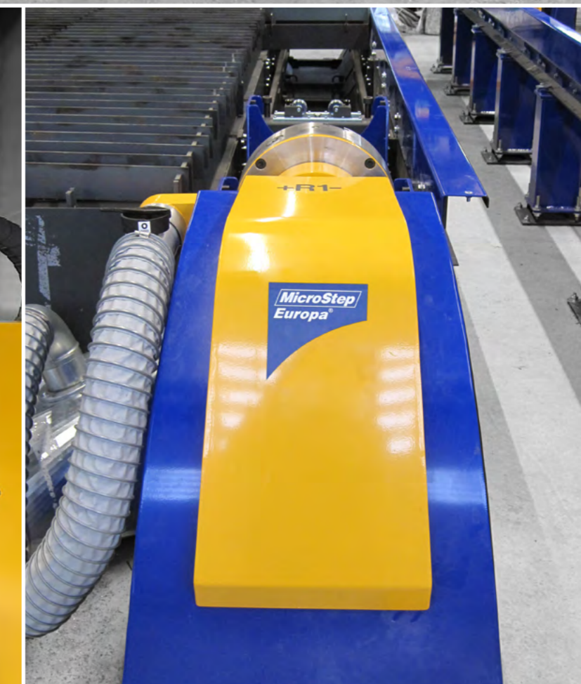
Mit dieser Rohrschneidvorrichtung können Rohre bis 300 mm Durchmesser bearbeitet werden
