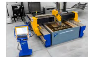
Für noch mehr Multifunktionalität und größere Bearbeitungsflächen hat MicroStep die AquaCut entwickelt. Die Wasserstrahlschneidanlage kann mit einem 5-Achsen-Rotator ausgestattet wie auch mit einer Plasma- oder Gewindeeinheit kombiniert werden. Zusätzlich gibt es noch viele weitere Konfigurationsmöglichkeiten passgenau auf Ihre Anforderungen.
