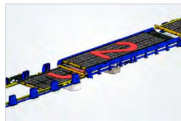
Das System besteht aus drei getrennten Arbeitsbereichen, die das gleichzeitige Laden/Entladen und die Bearbeitung von Werkstücken ermöglichen, z. B. Schneiden, Markieren, Primerentfernung und mehr. Der Tischwechsel zwischen den Zonen wird synchronisiert, um eine höchstmögliche Effizienz der Produktion zu ermöglichen.
