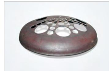
Die stabile Bauweise der MG Baureihe mit massiver Portalbrücke ermöglicht individuelle Behälterbodenbearbeitung bis zu 6.000 mm Ø. Je nach Schneidkopf (2D oder 3D) und entsprechend dimensioniertem Z-Achsen-Hub kann sogar eine Bearbeitung von der Wölbung mit Übergang auf die Krempe erfolgen oder auch die Krempe selbst bearbeitet werden.
