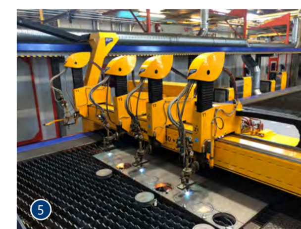
Eines der insgesamt vier Schneidportale bei Doppelmayr wurde mit vier Autogenbrennern zum Brennschneiden hoher Materialstärken ausgerüstet. Die mehr als 60 Meter lange Fertigungsstraße läuft im Dreischichtbetrieb am Hauptsitz des Technologieführers in Wolfurt (Österreich) am Bodensee.
