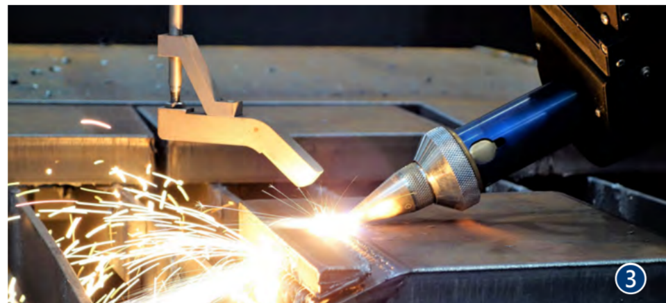
3 Integriert wurde auch MicroSteps Autogenrotator, der unter anderem zur Blechbearbeitung genutzt wird. Hier im Bild wird eine „obere Y“-förmige Schweißfläche vorbereitet.
