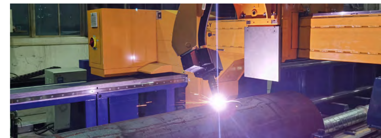
Die drei PipeCut Anlagen zur 3D-Bearbeitung von Rohren und Behälterböden bei Gree: Rohre können bis zu einer Länge von 12 Metern und einem maximalen Durchmesser von 610 mm bearbeitet werden wie auch Behälterböden bis zu einem Durchmesser von 1.200 mm.
