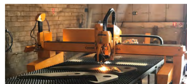
Der führende spanische Maschinenbauer Solintal hat durch den Autogenrotator die Produktionszeit von bis zu 160 mm starken Brennteilen mit komplexen Fasengeometrien an nicht-linearen Konturen revolutioniert: Für Teile, die früher sechs Stunden Produktionszeit in Anspruch genommen haben, benötigt Solintal jetzt beispielsweise nur noch 45 Minuten.
