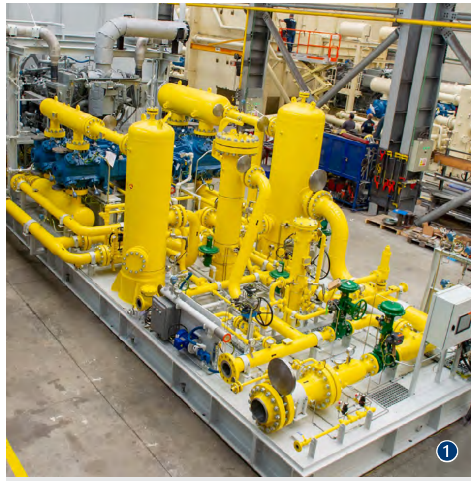
1 Euro Gas Systems entwickelt und produziert vielseitige Kompressorlösungen. Hier im Bild ist die zweistufige Verdichtereinheit Ariel KBK4. Die Produktion solcher Geräte ist eine große Herausforderung. MicroSteps DRM mit einer enormen Bearbeitungspalette wird hierbei vollständig genutzt.
