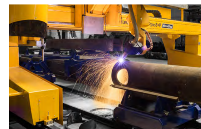
MicroStep hat eine Vielzahl von Lösungen für die hochpräzise 3D-Bearbeitung von Rohren, Profilen und Trägern entwickelt – einschließlich vollautomatischer Materialbehandlung.
