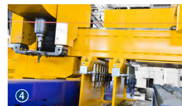
MicroStep-Bohrsupport inklusive Innenkühlung und automatischem Werkzeugwechsel sowie automatischem Magazin für 16 Werkzeuge. Damit ist es möglich verschiedene Werkzeugtypen innerhalb eines Schneidprogramms zu verwenden.
