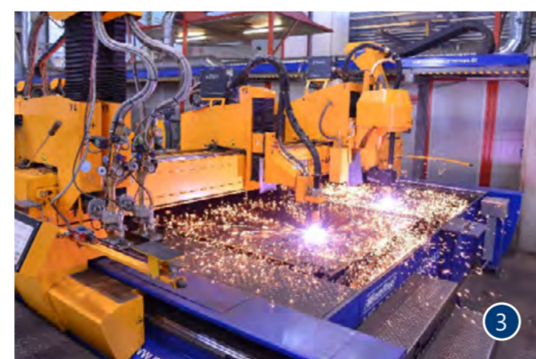
Für die Firma Doppelmayr installierte MicroStep eine leistungsstarke Bohranlage der DRM Baureihe 1 und zwei Plasma-Autogenschneidanlagen der MG Baureihe mit je zwei Portalen 2 + 3. Die beiden MG Anlagen wurden mit je einer CCD-Kamera 4 ausgestattet für höchste Präzision beim Zuschnitt vorgebohrter Teile.
