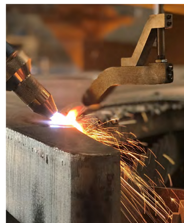
Für die Arbeiten von Solintal (z. B. 45°-Y-Fasen an Teilen mit einer Dicke von 160 mm) war Autogenschneiden natürlich die Technologie der Wahl. Die Bewegungsfähigkeiten des Rotators erlauben es, eine große Vielfalt von Konturformen zu schneiden. Eine hohe Maßhaltigkeit wird durch die Möglichkeit der Autokalibrierung des Autogenrotators gewährleistet - dank löschen MicroSteps patentierter ACTG-Technologie.
