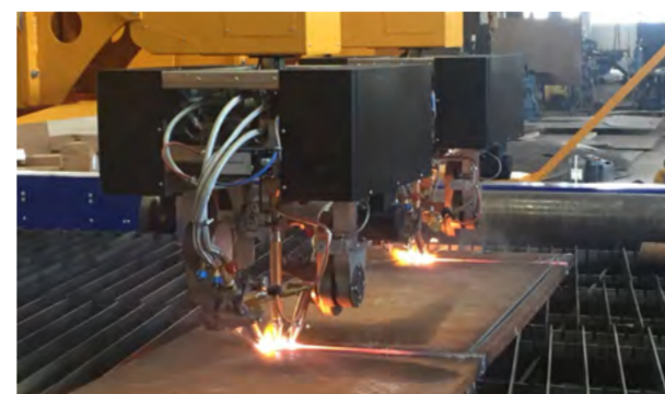
Mit einem Autogen 3-Brenneraggregat können ebenfalls K-Fasen geschnitten werden, bei der Materialdicke ist diese Lösung aber deutlich eingeschränkt.
