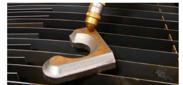
Das Schneidergebnis ist aufgrund der höheren Steifigkeit des Systems im Vergleich zum Roboter äußerst präzise.
