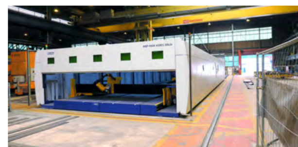
Die Maschine ist mit einem 3D-Faserschneidkopf und einer 8 kW Laserquelle ausgestattet, mit dem Chantiers de l'Atlantique die Schweißnahtvorbereitung an bis zu 20 m langen Teilen mit Dicken bis zu 16 mm und Fasenwinkeln bis zu 45° anarbeiten kann.
