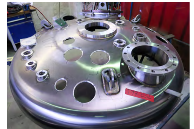
Rund eineinhalb Wochen betrug die typische Durchlaufzeit bei komplexen Behälterböden mit vielen Stutzen (siehe beispielsweise Foto oben) – heute kann GEA bei Bedarf in einem Tag produzieren.
