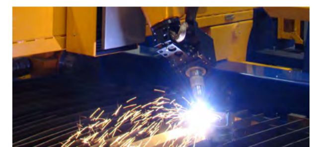
Mit dem endlosdrehenden Rotator können dann V-, Y-, und unter bestimmten Bedingungen sogar X- und K-Fasen nachträglich angearbeitet werden.
