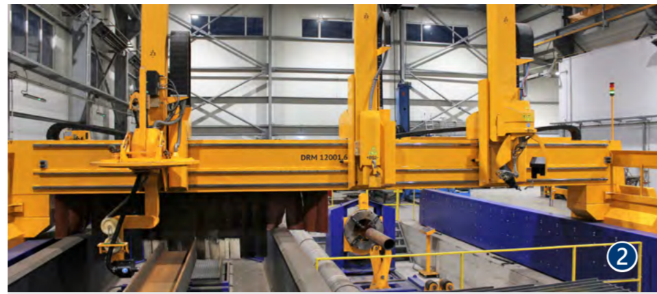
2 Mit der DRM kann EGS verschiedene Geometrien multifunktional bearbeiten. Das Schneidcenter ist mit drei Werkzeugplätzen ausgestattet: für den Zuschnitt von Trägern (links), für Bleche und Behälterböden (vorne rechts) sowie für Rohre (hinten rechts).
