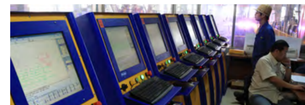
24/7 im Betrieb: Die Produktionslinie (Bild links) bei einem chinesischen Maschinen- und Anlagenbauer wird von einem zentralen Leitstand (Bild oben) aus gesteuert. Insgesamt acht CNC-Plasmaschneidanlagen von MicroStep werden dabei automatisiert von einem Demag-Prozesskran beladen.
