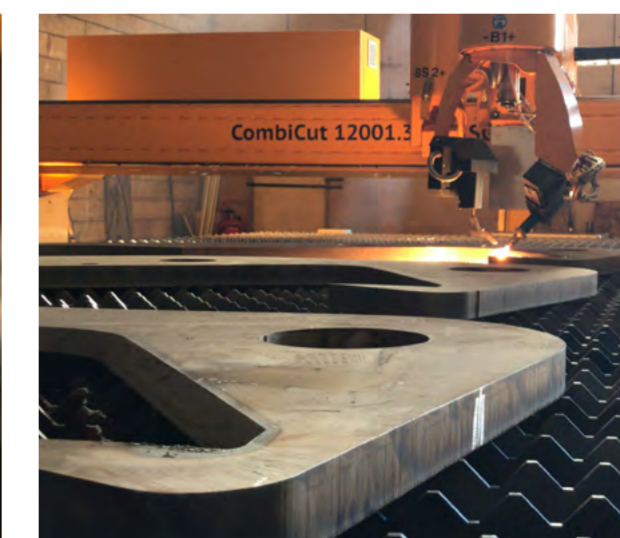
Für die Arbeiten von Solintal (z. B. 45°-Y-Fasen an Teilen mit einer Dicke von 160 mm) war Autogenschneiden natürlich die Technologie der Wahl. Die Bewegungsfähigkeiten des Rotators erlauben es, eine große Vielfalt von Konturformen zu schneiden. Eine hohe Maßhaltigkeit wird durch die Möglichkeit der Autokalibrierung des Autogenrotators gewährleistet - dank löschen MicroSteps patentierter ACTG-Technologie.
