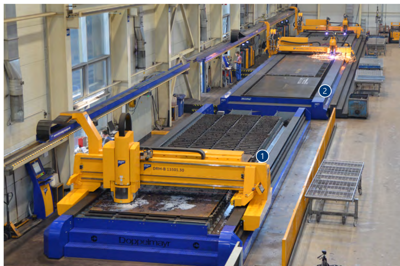
Für die Firma Doppelmayr installierte MicroStep eine leistungsstarke Bohranlage der DRM Baureihe 1 und zwei Plasma-Autogenschneidanlagen der MG Baureihe mit je zwei Portalen 2 + 3. Die beiden MG Anlagen wurden mit je einer CCD-Kamera 4 ausgestattet für höchste Präzision beim Zuschnitt vorgebohrter Teile.
