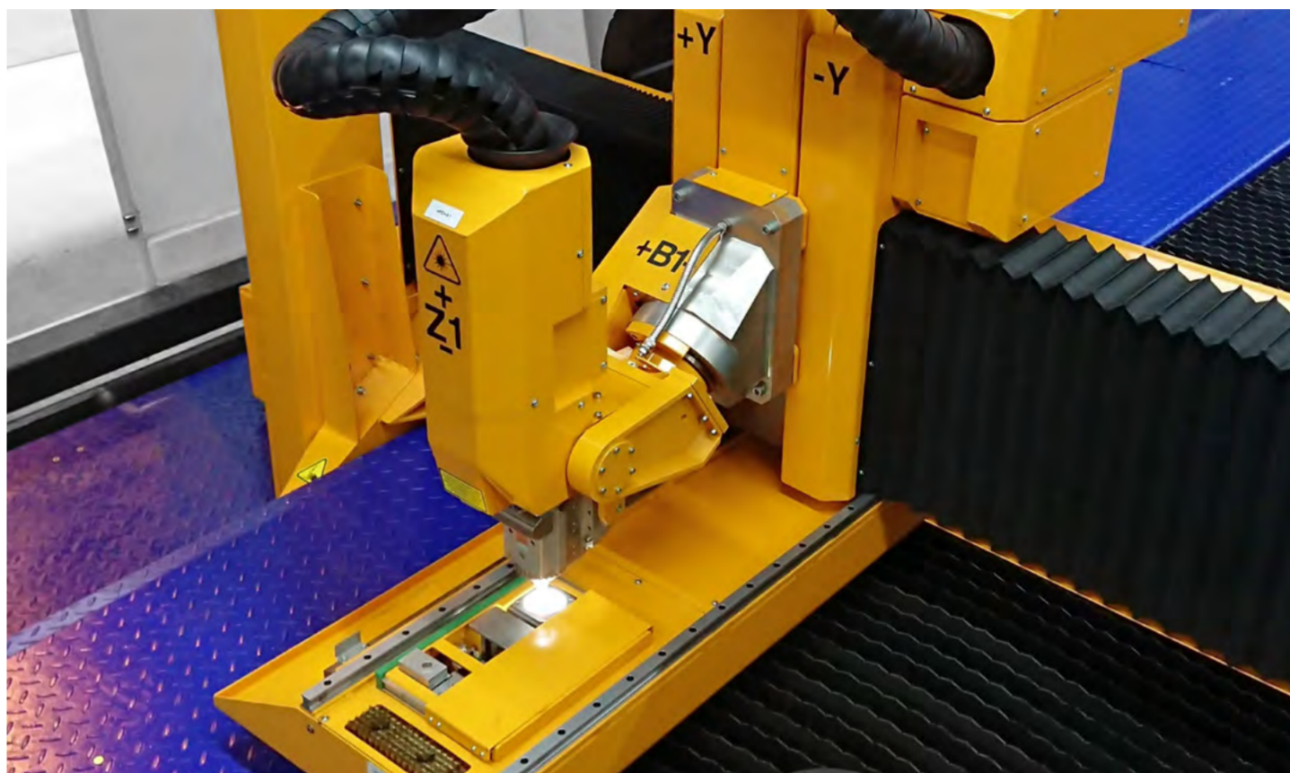
Chantiers de l'Atlantique entschied sich, in einen großen Faserlaserschneider MSF Max zu investieren. Es ist eine 50 m lange Maschine mit zwei 21 x 3,5 m Schneidzonen. (oben)
