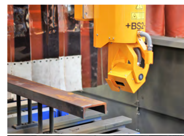
Plasmaschneiden von Rohren. Die Rohrschneidvorrichtung ermöglicht das automatische Schneiden von Rohren bis zu 2.000 mm Ø, 6 m Länge und 7 Tonnen Gewicht.
