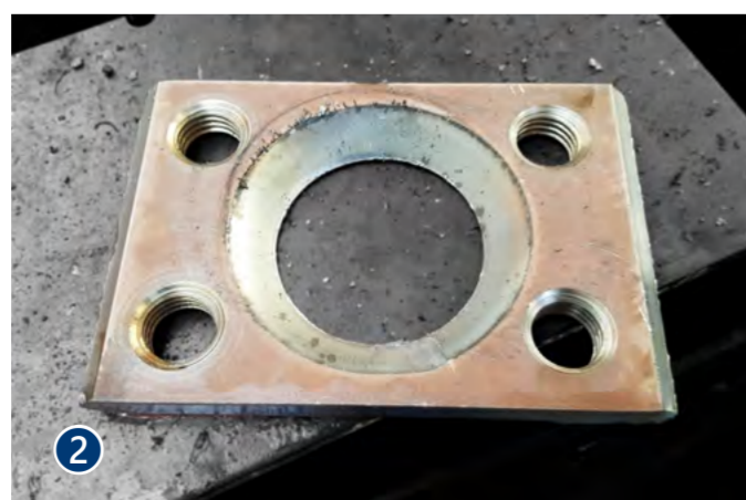
Ein Hardox-Teil, das auf einer DRM gebohrt, mit Gewinde versehen und anschließend mit Plasma ausgeschnitten und gefast wurde.
