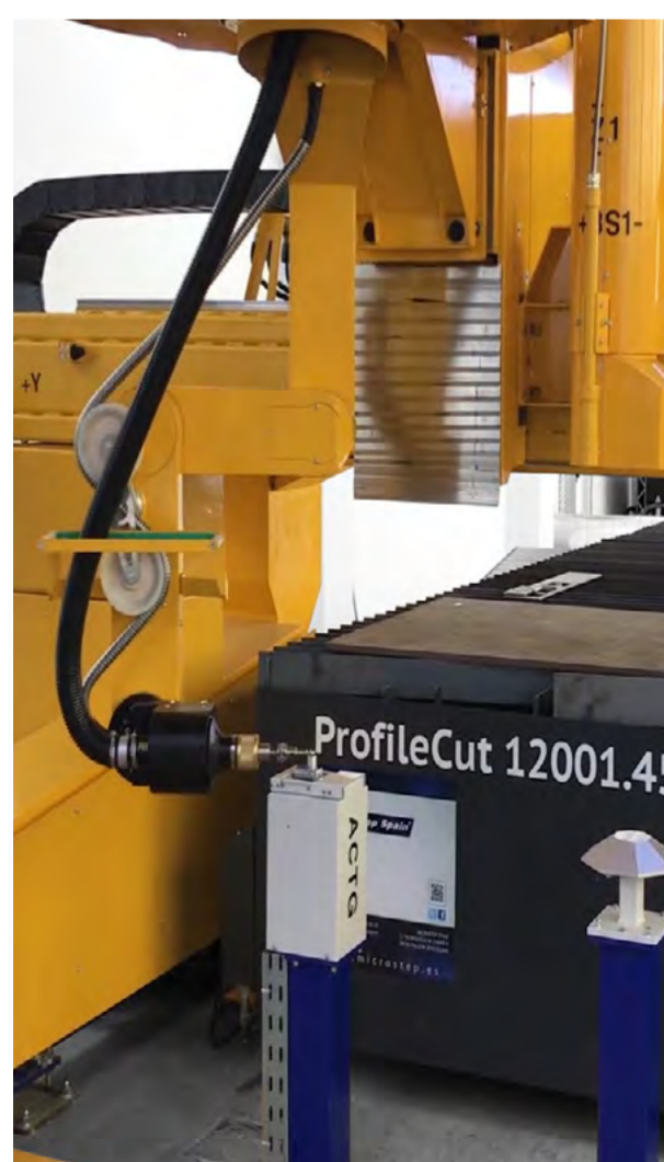
Das Kalibriersystem ACTG® sorgt für höchste Präzision – prozesssicher auch im Mehrschichtbetrieb. Der im Bild zu sehende Plasmarotator „Pantograph“ kann bis zu 120° geneigt werden.
