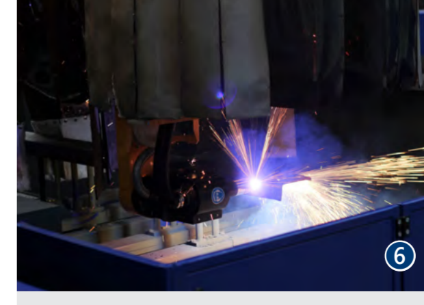
Scan und 3D-Zuschnitt eines U-Trägers
