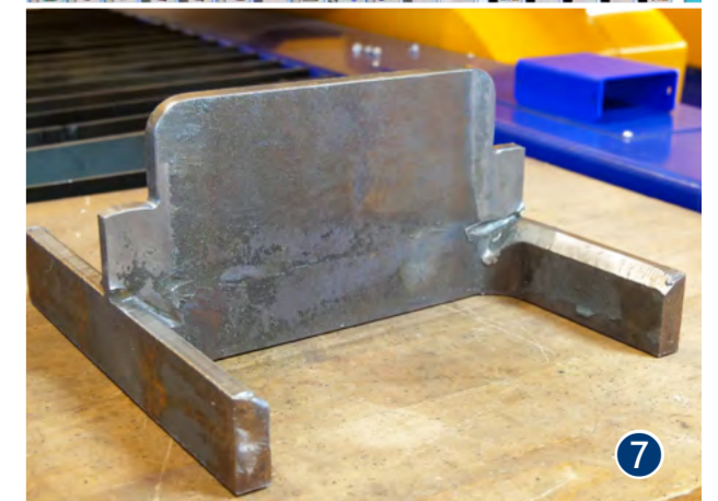
Oben: Screenshot der MicroStep IMSNC Steuerung mit geladenem Schneidprogramm zum Schneiden des Stegs des H-Trägers (Ausgabe aus der 3D CAM Software mCAM); Unten: das fertig geschnittene Teil.
