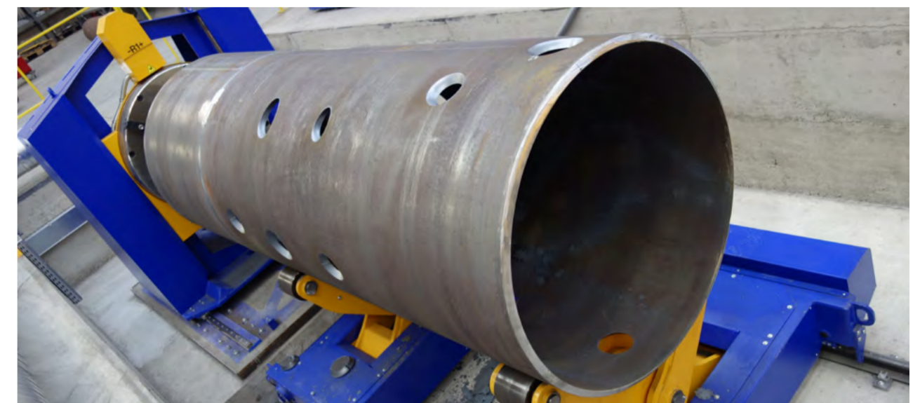
3D-Zuschnitt eines Behälterbodens mit Plasma (links) und Autogen (rechts). Die Maschine kann Böden bis zu einem Durchmesser von 2.000 mm schneiden.
