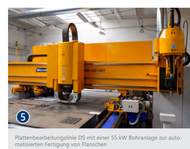
MicroStep-Bohrsupport inklusive Innenkühlung und automatischem Werkzeugwechsel sowie automatischem Magazin für 16 Werkzeuge. Damit ist es möglich verschiedene Werkzeugtypen innerhalb eines Schneidprogramms zu verwenden.
