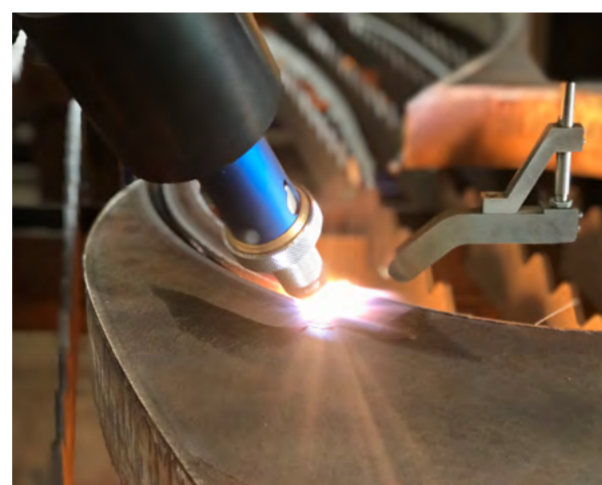
Der MicroStep Autogenrotator ist ein endlosdrehendes Fasenaggregat, welches speziell für die 3D-Bearbeitung von Flachmaterial mit hohen Materialstärken entwickelt wurde. Das System hat viele Vorteile im Vergleich zum Drei-Brenner-Aggregat oder zu einer Roboterlösung.
