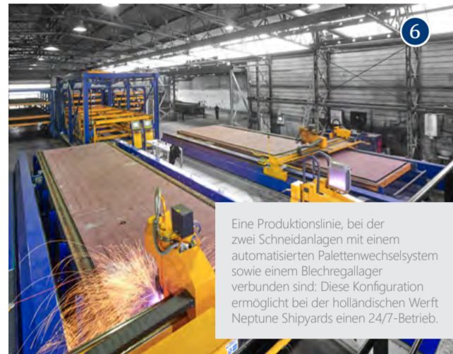
Auf einen vollautomatischen Wechseltisch zur Be- und Entladung ihrer Plasmaschneidanlage mit einer Netto-Bearbeitungsfläche von 3.000 x 3.000 mm setzt die BRÜGGEN Oberflächen- und Systemlieferant GmbH aus Deutschland.
