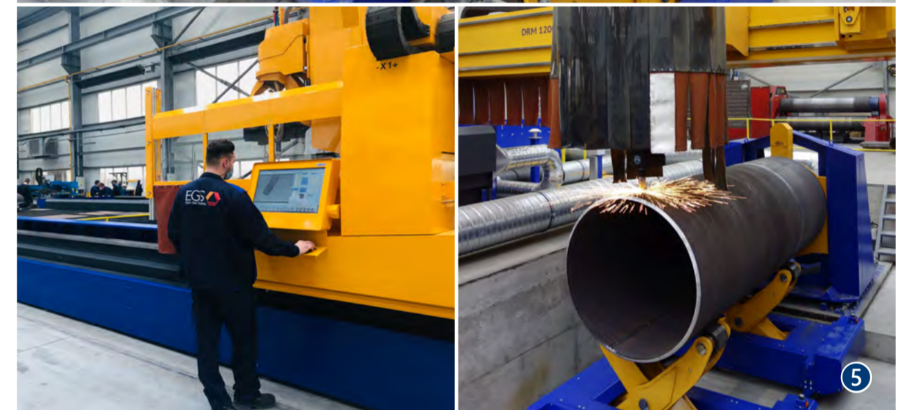
Plasmaschneiden von Rohren. Die Rohrschneidvorrichtung ermöglicht das automatische Schneiden von Rohren bis zu 2.000 mm Ø, 6 m Länge und 7 Tonnen Gewicht.
