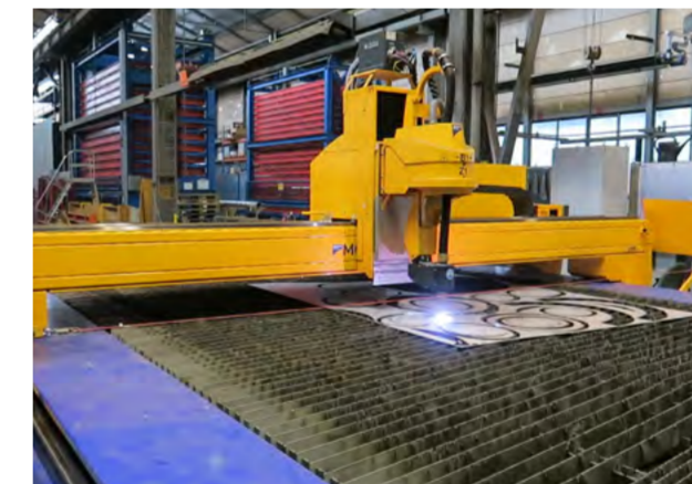
Die GEA Brewery Systems GmbH hat sich für eine multifunktionale MG Plasmaschneidanlage entschieden, mit der sowohl Bleche als auch Behälterböden bearbeitet werden können.
