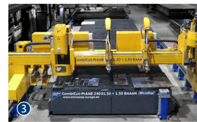
Eine multifunktional ausgestattete CombiCut mit Plasmarotator, zwei Autogenbrennern sowie einer Bohreinheit (Bohren bis 40 mm, Gewinden bis M33) inklusive 16-fach Werkzeugwechsler.
