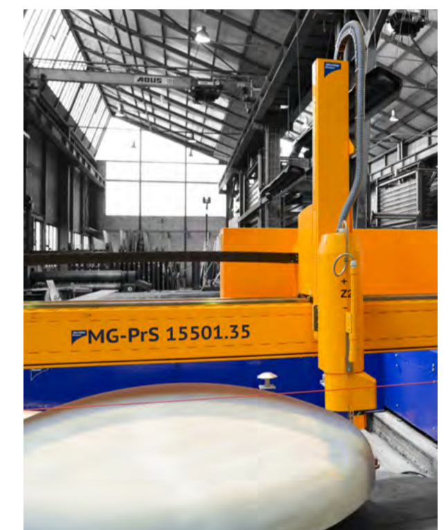
Die mScan-Technologie von MicroStep ermöglicht höchste Präzision bei der Behälterbodenbearbeitung. Ein auf dem Portal integrierter Laserscanner ermittelt dabei vorab die tatsächliche 3D-Oberflächengeometrie des Werkstücks.
