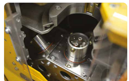
ATChanger: Magazin für 8 Brennerköpfe ATChanger: magazine for 8 torch heads
