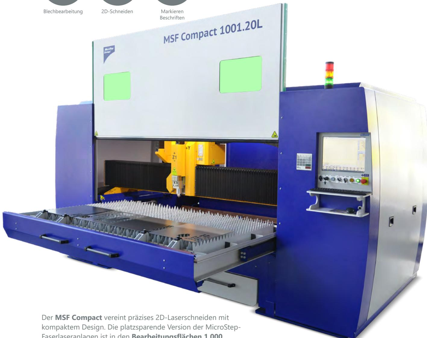
Der **MSF Compact** vereint präzises 2D-Laserschneiden mit kompaktem Design. Die platzsparende Version der MicroStep-Faserlaseranlagen ist in den **Bearbeitungsflächen 1.000 x 2.000 mm, 1.250 x 2.500 mm und 1.500 x 3.000 mm** erhältlich und überzeugt vor allem durch einen geringen Platzbedarf bei gewohnt hoher Schnittqualität. Ein manuell herausziehbarer Schneidstisch ermöglicht dabei ein einfaches und unkompliziertes Be- und Entladen.
