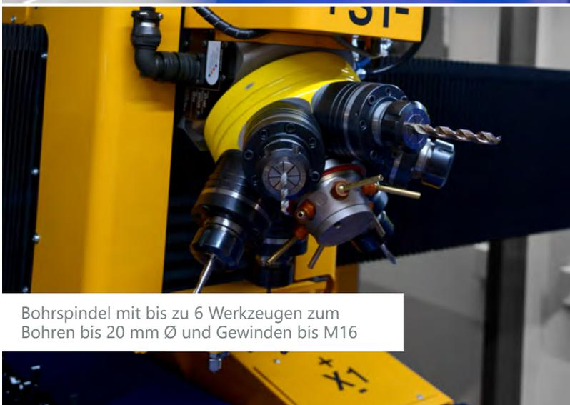
Bohrspindel mit bis zu 6 Werkzeugen zum Bohren bis 20 mm Ø und Gewinden bis M16
