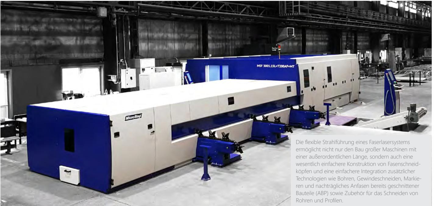
Die flexible Strahlführung eines Faserlasersystems ermöglicht nicht nur den Bau großer Maschinen mit einer außerordentlichen Länge, sondern auch eine wesentlich einfachere Konstruktion von Fasenschneidköpfen und eine einfachere Integration zusätzlicher Technologien wie Bohren, Gewindeschneiden, Markieren und nachträgliches Anfasen bereits geschnittener Bauteile (ABP) sowie Zubehör für das Schneiden von Rohren und Profilen.
