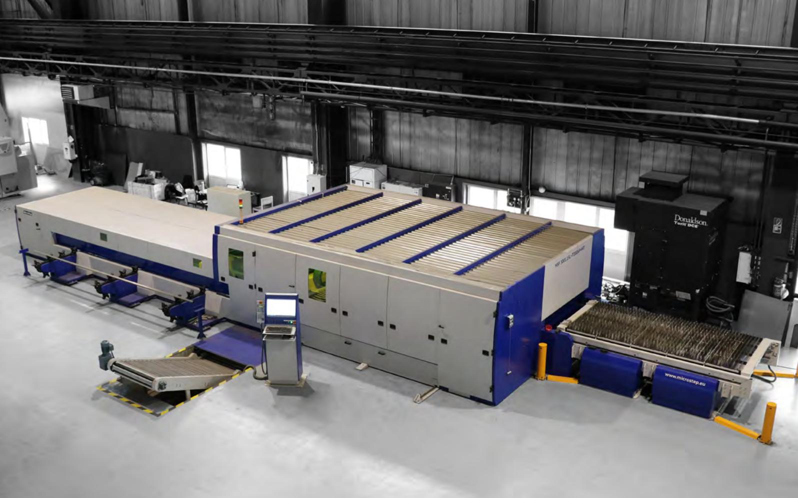
Flexible und hochdynamische CNC-Faserlaser-Schneidanlage bis 10 kW
