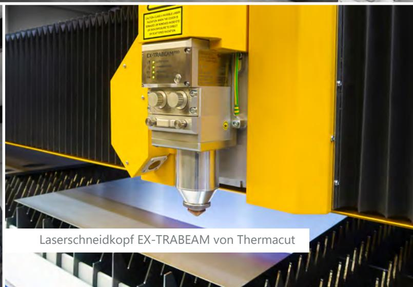
Laserschneidkopf EX-TRABEAM von Thermancut
