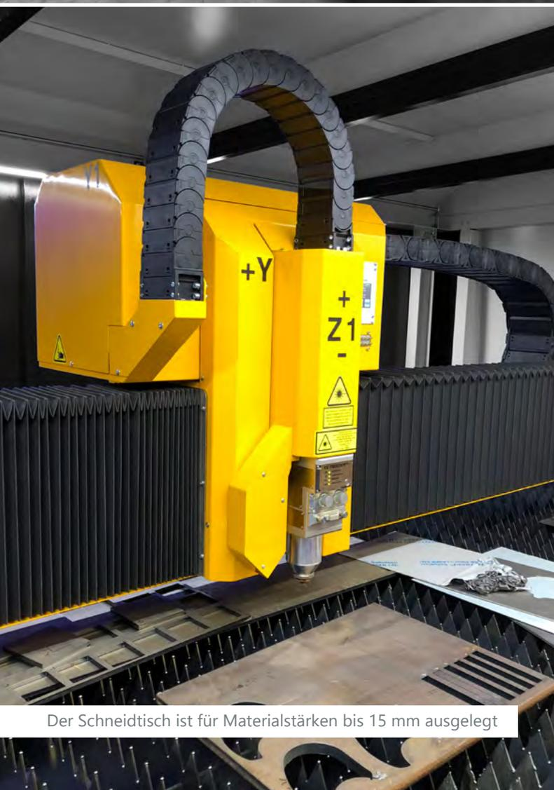
Der Schneidstisch ist für Materialstärken bis 15 mm ausgelegt
