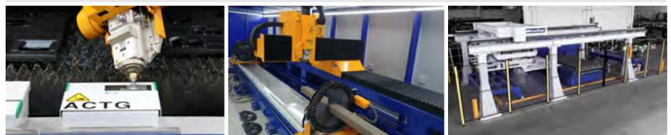
Der Laserfasenkopf ist mit dem Autokalibririersystem ACTG ausgestattet, so dass mögliche mechanische Ungenauigkeiten durch Gegenbewegungen der Maschine kompensiert werden. (oben links)
