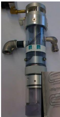
Die einfachste Art ist, den Sand in einen kleinen Dosierbehälter zu befördern und den Durchfluss zum Schneidkopf mit einer Drosselblende oder einem Rohr mit
