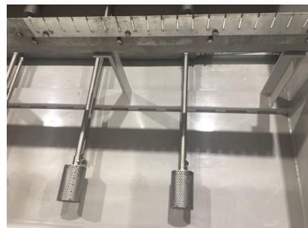
Absetzbecken befördert, wo das Wasser durch einen Filtersack wieder in den Vorlagebehälter läuft und von dort durch eine zweite Pumpe zum Aufwirbeln des abgesetzten Schlammes zurück in den Catcher gedrückt wird. Der Schlamm bleibt im Filtersack und wird nach dem Abtropfen zur Entsorgung gegeben.
