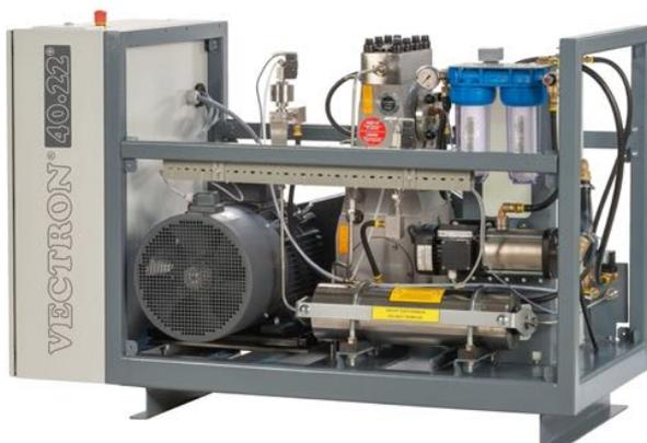
Die neuesten Generationen von Direktpumpen nehmen das benutzte Kühlwasser in Tanks komplett auf und verwenden es verlustfrei zum Schneiden. Das senkt die Betriebskosten und den Verschleiß.
