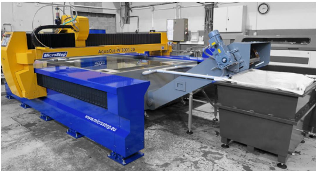
Bei der ersten Variante kann der Kratzförderer mit Abweisblechen kombiniert werden und sorgt für einen fast vollständigen Austrag des Schlammes und kleiner Abfallteile. Der Aufnahmebehälter kann mit normalen Säcken bestückt werden, in denen der Schlamm der Entsorgung zugeführt wird.
