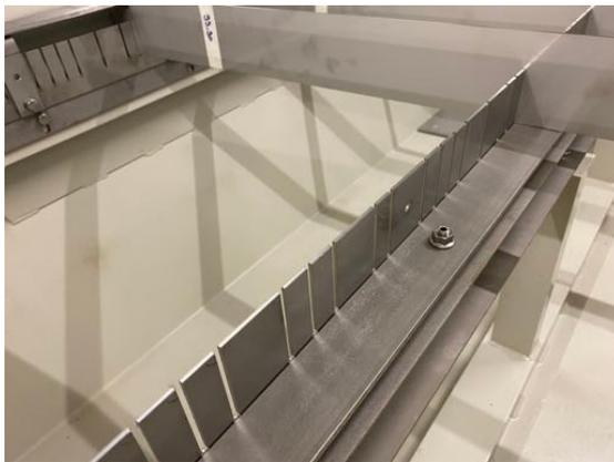
Oder man baut den Catcher mit diversen Verstrebungen auf, die dann auch die Werkstückauflage tragen. Je stabiler der Tank dabei ausgeführt wird, desto steifer ist die Auflage.
