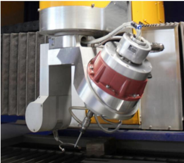
Der große Unterschied besteht darin, dass beim *dynamischen* Winkelfehlerausgleich der Schneidkopf immer wieder den aktuellen Schneidbedingungen angepasst wird.
