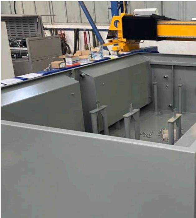
Die elegantere Lösung sind Tanks, die unter der Wasseroberfläche gleich in den Catcher integriert und mit Druckluft beaufschlagt werden. Die einströmende Luft verdrängt das Wasser und hebt den Wasserspiegel an.
