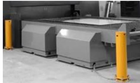
Bei allen diesen Punkten ist die Lichtschranke ein großes Problem und im Betrieb sehr oft ein KO Kriterium. Fast alle Hersteller bieten Lichtschranken an. Teils als Option, teils als zwingend erforderlichen Bestandteil der Installation. Der Unterschied liegt in der Beurteilung der Gefährdung durch den Hersteller.
