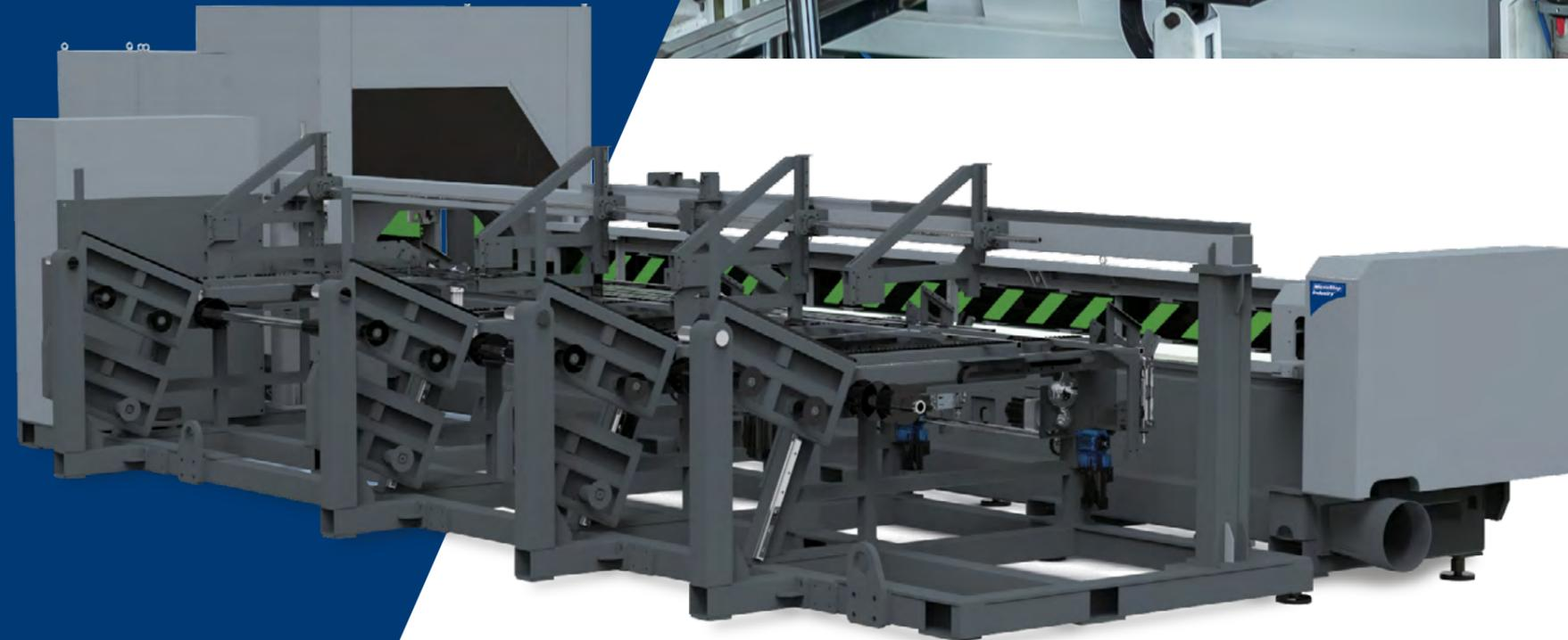
Die Benutzer können das Ladegut in allen definierten Standardgrößen einlegen und mit äußerst geringem manuellem Aufwand sofort mit der Serienproduktion starten. Rundrohre, quadratische und rechteckige Profile sowie offene Profile oder I- bzw. H-Träger werden einfach eingelegt und dann zur Längenmessung und Bestimmung der Schnittreihenfolge in den Wartebereich befördert.
