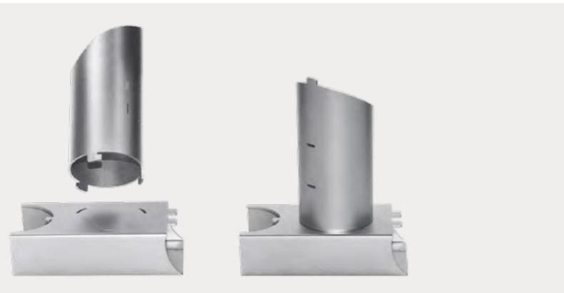
Ersetzen Sie die zeitaufwändige Fixierung von Teilen für das Verschweißen durch Stecker-, Schwalbenschwanz- und Bajonettanschlüsse!
