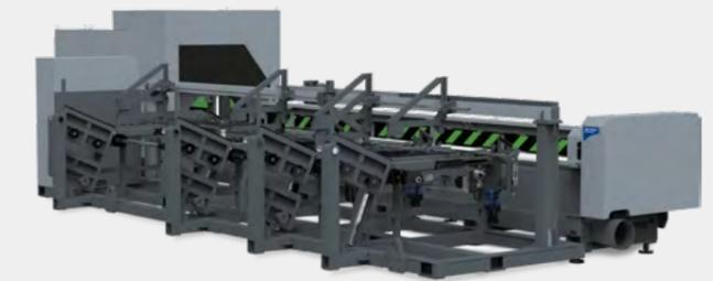
Die Benutzer können das Ladegut in allen definierten Standardgrößen einlegen und mit äußerst geringem manuellem Aufwand sofort mit der Serienproduktion starten. Rundrohre, quadratische und rechteckige Profile sowie offene Profile oder I- bzw. H-Träger werden einfach eingelegt und dann zur Längenmessung und Bestimmung der Schnittreihenfolge in den Wartebereich befördert.
