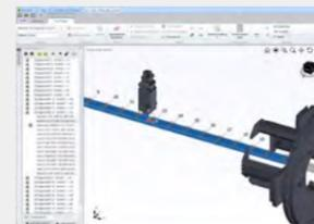
Die Werkzeugauswahl erfolgt immer unter Berücksichtigung der technologischen Parameter und Anlagengrenzen. Auch hier werden Features wie Mikrostege, Schrott- oder Trennschnitte nach Wunsch automatisch generiert.
