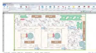
Die Technologiezuweisung innerhalb eines Schachtelplans erfolgt komplett automatisch. Hierbei werden sowohl An- und Ausläufe als auch intelligente Features wie z. B. Mikrostege, Sparschnitte, Fly-Cut und Resttafelschnitte automatisch generiert.
